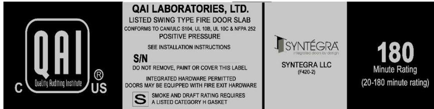
Models / Ratings: **180 MINUTE\* HONEYCOMB CORE HOLLOW METAL FIRE DOORS:**
